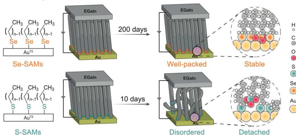
Figure : Schéma de l'évolution des structures des SAMs préparées à partir d'alkylséléniures ou d'alkylthiols et stockées sous conditions ambiantes pendant 200 jours pour des SAMs à base de Se (haut) et 10 jours pour des SAMs à base de S (bas).
